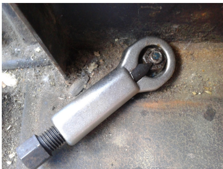
Пример правильного расположения гайколома
