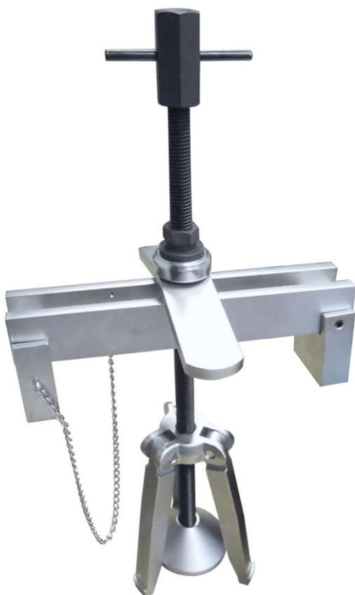
6. Вращая винт (2) за рукоятку, убедитесь, что 3-х лапый захват (5) всеми лапами упёрся в гильзу. Вращая гайку (3) и придерживая винт (2), начните извлечение гильзы. Если гильза идет туго, следует применить обратный молоток (1), установив его сверху на винт (2).
