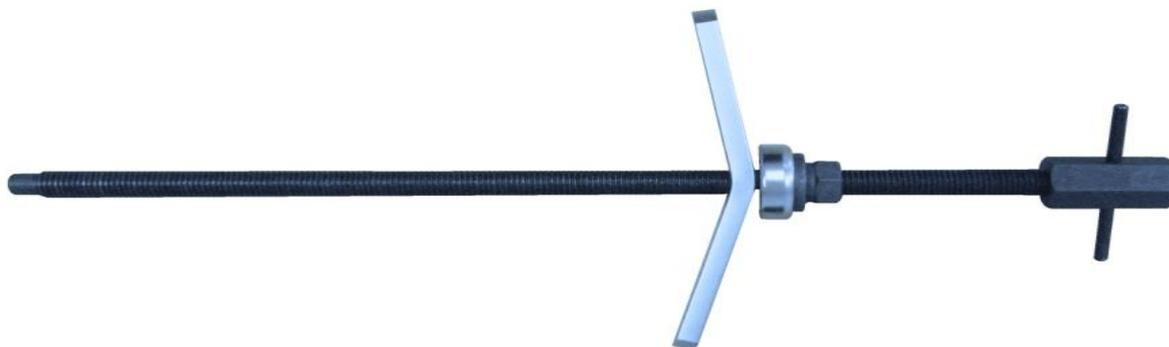
3. Установите 3-х лапый захват (5), накрутив его на винт (2).
