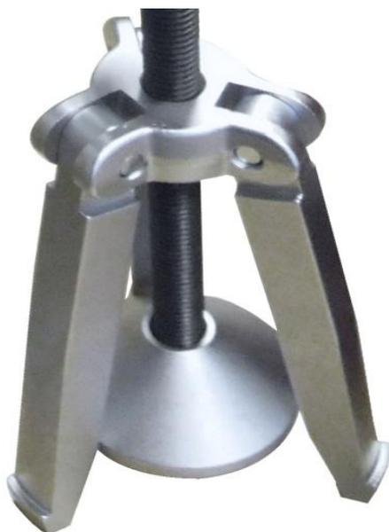
5. Установите съемник в гильзу, наденьте опору (8) и уприте её в блок цилиндров.
