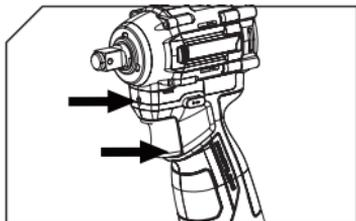
1. Нажмите на выключатель. Устройство начнет свою работу. Для увеличения числа оборотов нажмите на выключатель сильнее. Во время работы светодиодная лампа может использоваться для освещения рабочей зоны.
