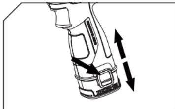
1. Вставьте аккумулятор в электроинструмент до упора, чтобы он зафиксировался со щелчком.
