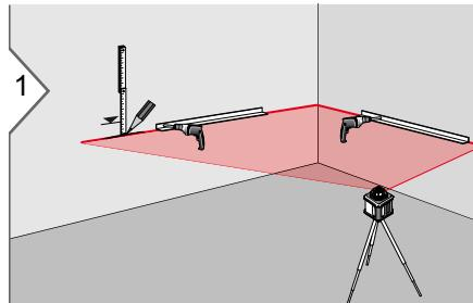
Включить лазер. Отрегулировать высоту лазера по известной опорной отметке для точек крепления. Использовать автоматический режим или режим сигнала тревоги H.I. и дать лазеру выполнить самовыравнивание.
