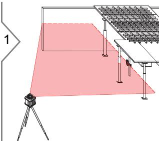
Включить лазер. Использовать автоматический режим или режим сигнала тревоги Н.И. и дать лазеру выполнить самовыравнивание.
