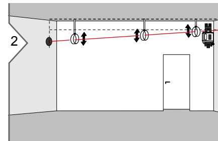
Отрегулировать трубные зажимы по лазерному лучу.
