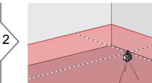
После включения запускается автоматический режим. Как только прибор выполнил самовыравнивание, головка лазера начинает вращаться.
