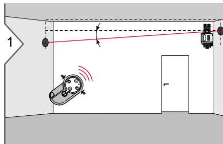
Закрепить лазер вместе в настенном креплении на стене. Переключиться в ручной режим. Наклонить лазерный луч к опорной отметке.
