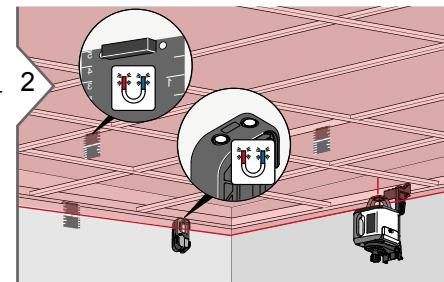
Включить лазер. По необходимости отрегулировать высоту лазера. Использовать автоматический режим или режим сигнала тревоги Н.И. и дать лазеру выполнить само выравнивание. Использовать визирную пластину или приемник для выравнивания подвесной потолочной решетки.
