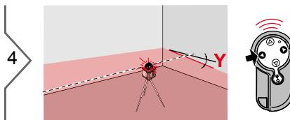
Наклонить ось Y плоскости лазера с помощью пульта.
