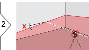
Наклонить ось X плоскости лазера с помощью пульта.
