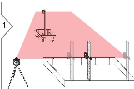
Включить лазер. Использовать автоматический режим или режим сигнала тревоги Н.И. и дать лазеру выполнить самовыравнивание.
