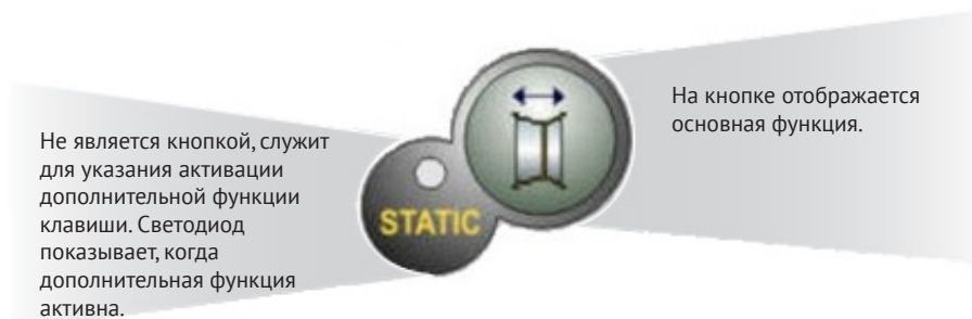
Рис. F1а. Пример кнопки с указанием основной и дополнительной функции
