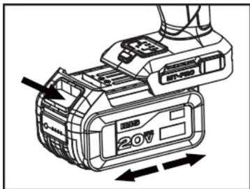
1. Вставьте аккумулятор в электроинструмент до упора, чтобы он зафиксировался со щелчком.
