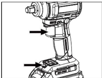
1. Нажмите на выключатель. Устройство начнет свою работу. Для увеличения числа оборотов нажмите на выключатель сильнее. Во время работы светодиодная лампа может использоваться для освещения рабочей зоны.
